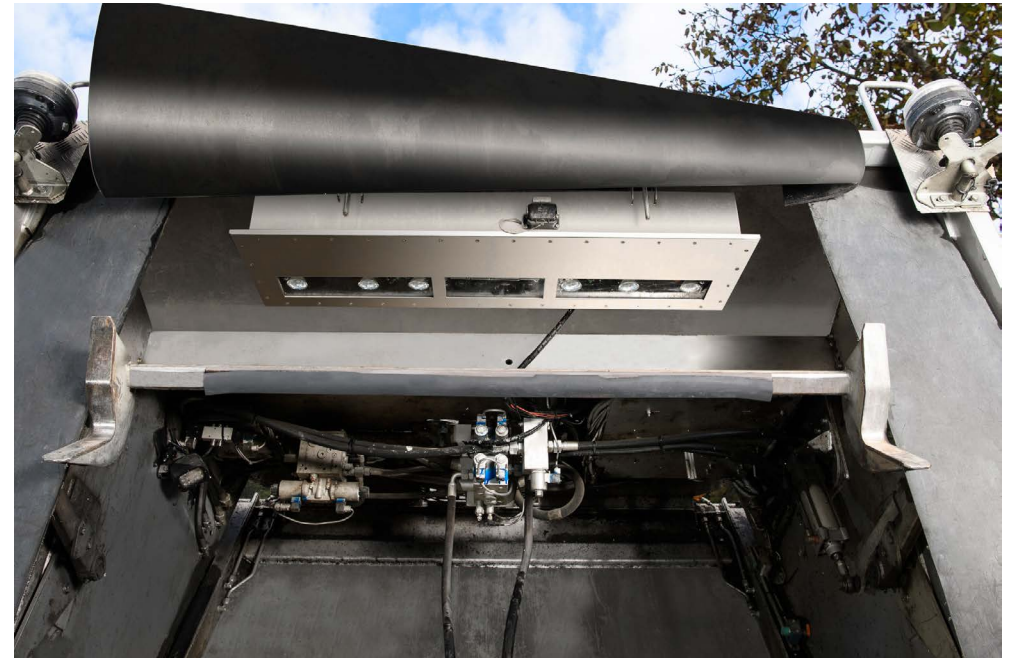
Abbildung 12: Wertstoffscanner am Müllsammel-LKW erkennt Fehlwürfe, Quelle: Saubermacher/Pixelmaker
